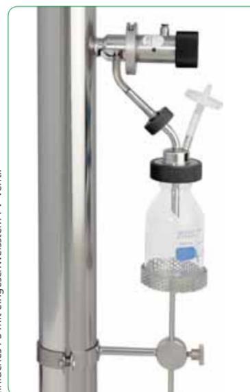
PS mit integrierter Dampfsperre
