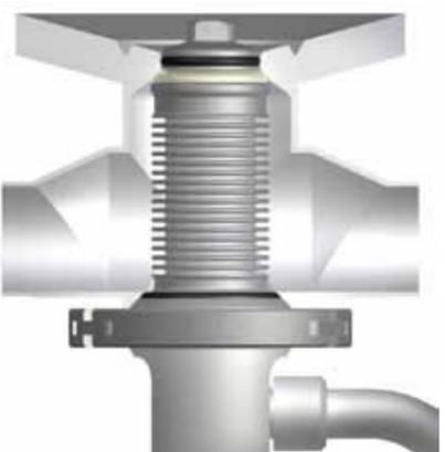
Das Leckage-Bodensitzventil DT ist von der Funktionsweise identisch mit dem Leckageventil LV.
